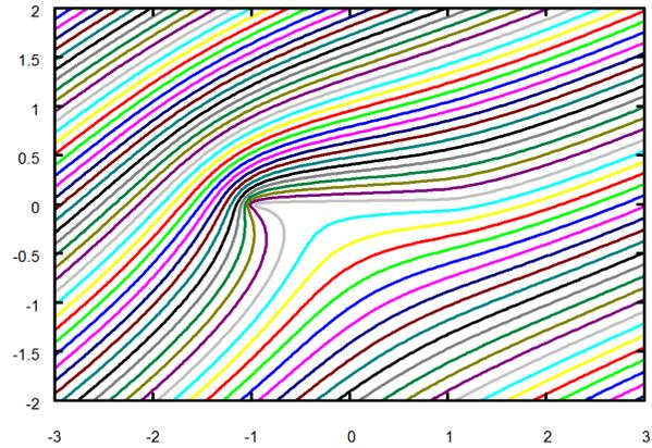
図 7.1.2: 二次元平板翼まわりの流れ
