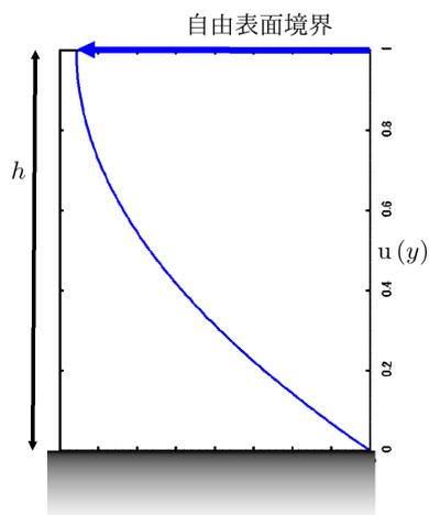
図 8.2.5: 傾斜した板の上の流体流速
