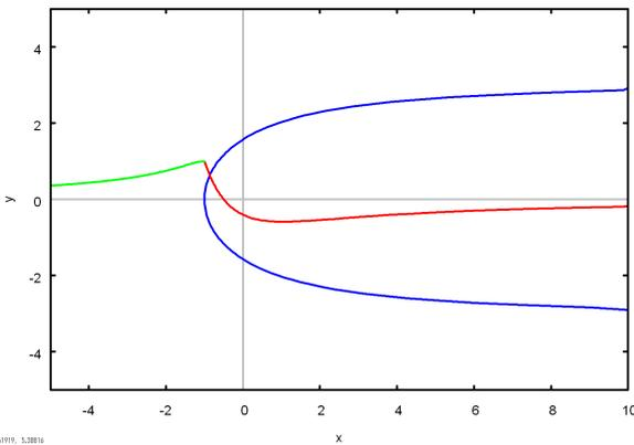
図 5.3.2: 一様流中のわき出しの物体表面圧力分布
