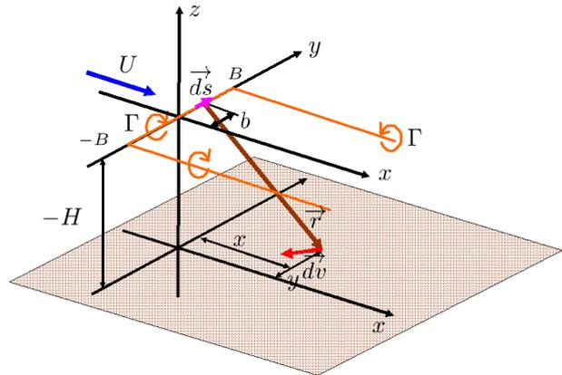
図 7.2.7: 地面における誘導速度
