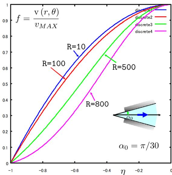
図 8.3.14: 二次元拡大流路流速分布 流速  $\alpha_0 = \pi/30$
