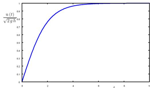
図 4.3.2: タンク側壁につけた水平な非定常管内流速
