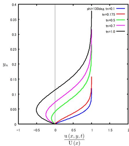
図 8.7.25: 流速分布の時間経過  $\phi = 130deg.$
