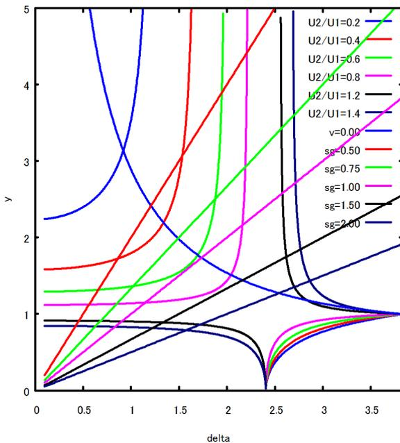
図 8.8.12: 外側の流速変化と流路の拡大率の関係
