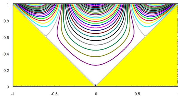
図 9.6.14: V 字断面水路 流線
