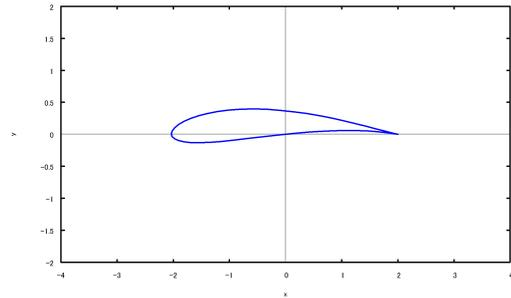
図 7.1.12: 翼厚+キャンバーありの翼形状
