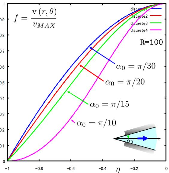
图 8.3.17: 二次元扩大平面流路流速分布 角度变化 R=100
