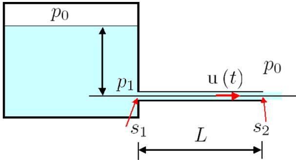
図 4.3.1: タンク側壁につけた水平管
