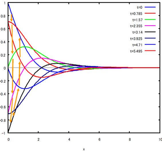
図 8.6.2: 振動平板による流れ
