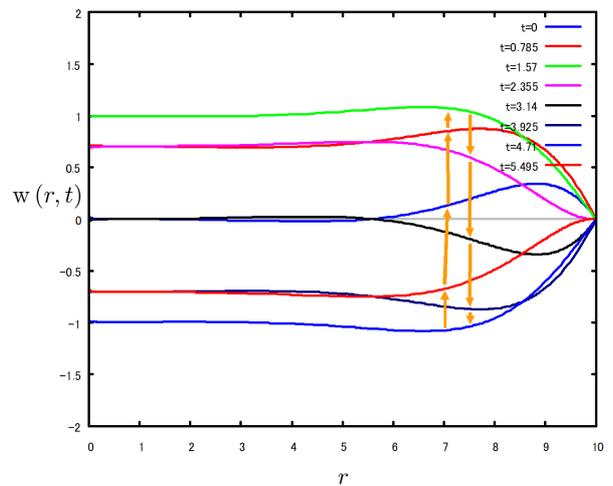
図 8.6.14: 円管内での変動圧力勾配による流れ R = 10
