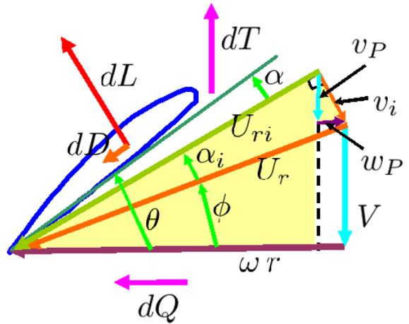
図 7.3.3: プロペラ翼素に流入する流れ
