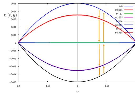
図 8.6.12: 平行平板内での変動圧力勾配による流れ  $h = 0.1$
