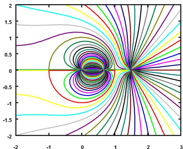
図 5.3.20: 円柱の外に置いたわき出しの流線
