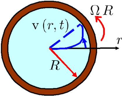
図 8.7.12: 円筒内静止流体で突然回転した円筒の流れ
