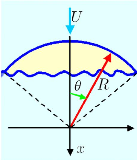
図 6.2.17: 液中での大きい気泡の運動
