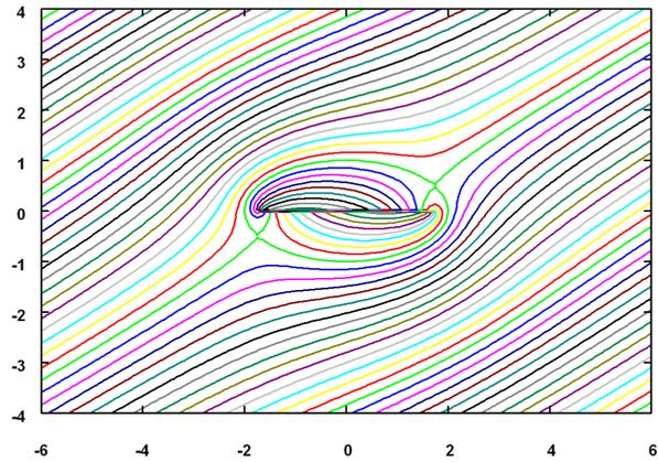
図 5.3.12: 一様流中の楕円柱まわりの流れ (Joukowski 変換)(5.3.23) 式による :  $\alpha = 30^\circ, a = 2, b = 1, U = 1$
