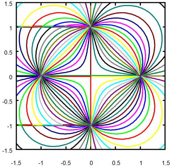
図 5.3.42:  $w$  平面の流れ 平板に垂直にぶつかるジェット
