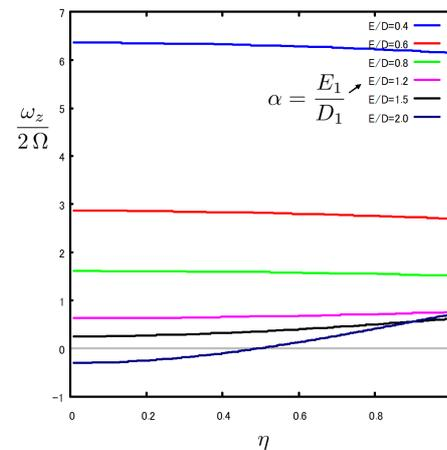
图 8.8.5: 轴方向涡度:  $\omega_z$  半径方向分布  $\sigma = 1.0$
