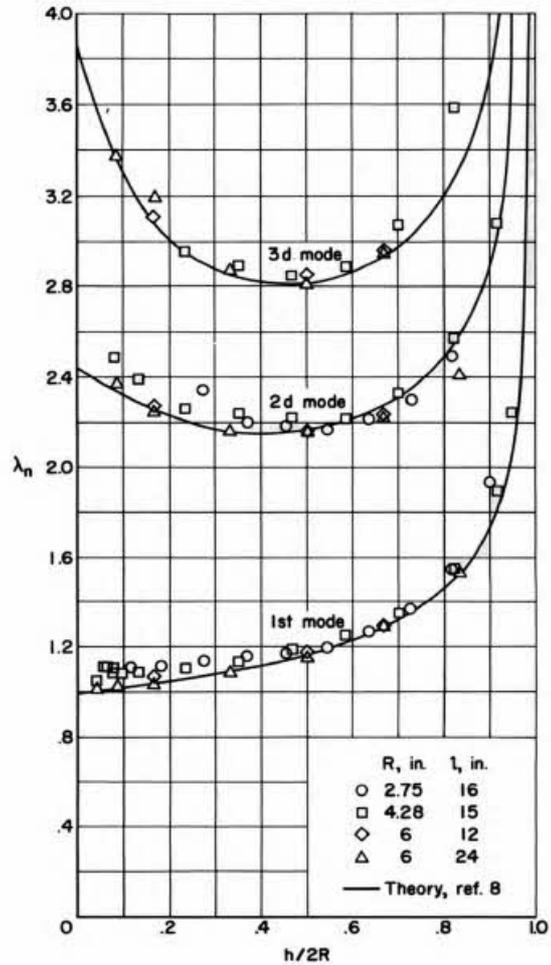
図 9.6.31: 水平円筒タンクの横（半径）方向の荷液の固有円周波数
