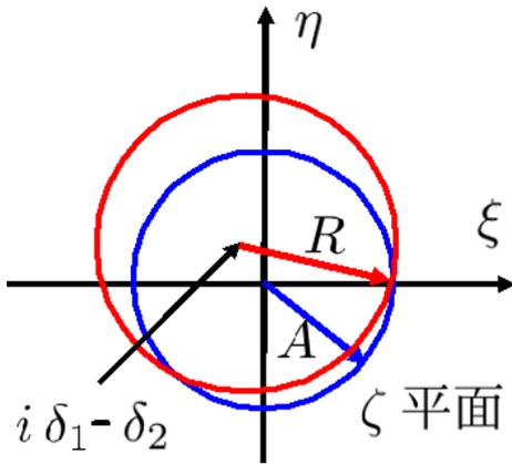
図 7.1.11: 翼厚+キャンバーありの翼への写像
