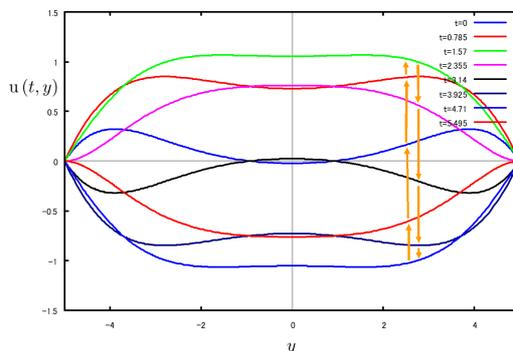
図 8.6.11: 平行平板内での変動圧力勾配による流れ  $h = 5$
