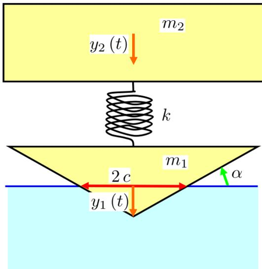
図 9.7.3: 着水衝撃の構造応答
