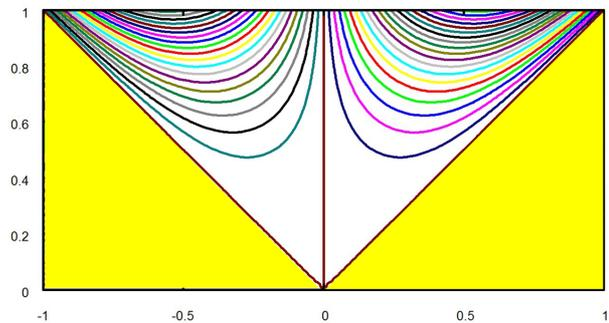
図 9.6.9: V 字断面水路 流線
