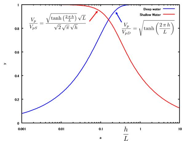
図 9.2.3: 深水、浅水時の位相速度
