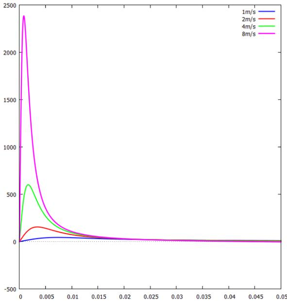
図 9.7.9: 衝撃荷重 突入速度の影響
