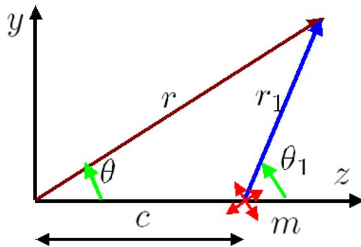
図 6.1.7: z 軸上にずれているわき出し
