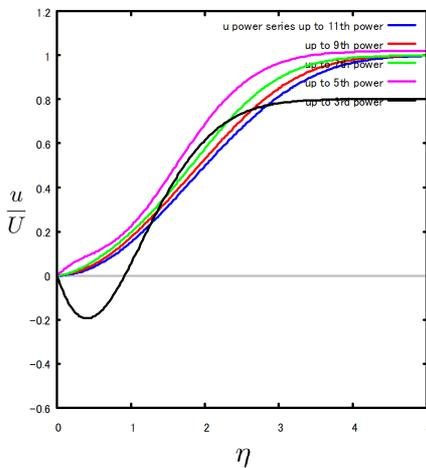
図 8.5.25:  $u$  流速分布 (次数の影響)  $\phi = 108.76\text{deg}$ .
