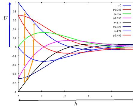
図 8.6.7: 自由表面を有する振動平板による流れ  $h = 5$
