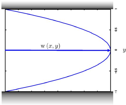
図 8.2.9: 楕円管内の流れ ( $x = 0$  断面)
