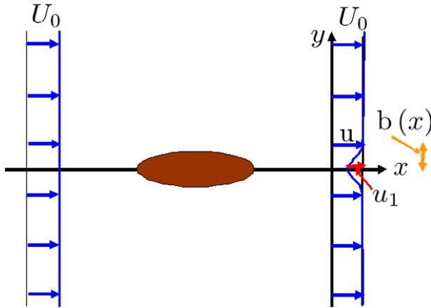
図 8.5.7: 二次元物体後方の流れ
