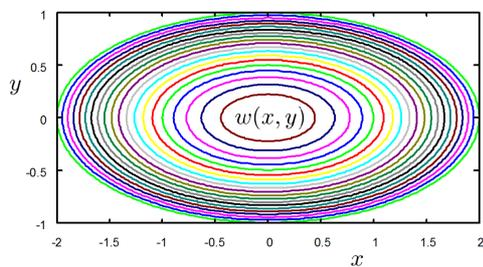
図 8.2.10: 楕円管内の流れ (等流速線図)
