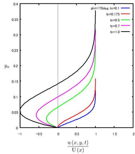
図 8.7.27: 流速分布の時間経過  $\phi = 170deg.$
