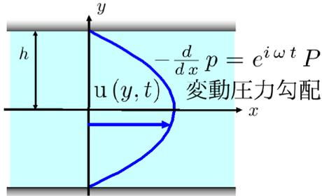
図 8.6.9: 平行平板内での変動圧力勾配による流れ
