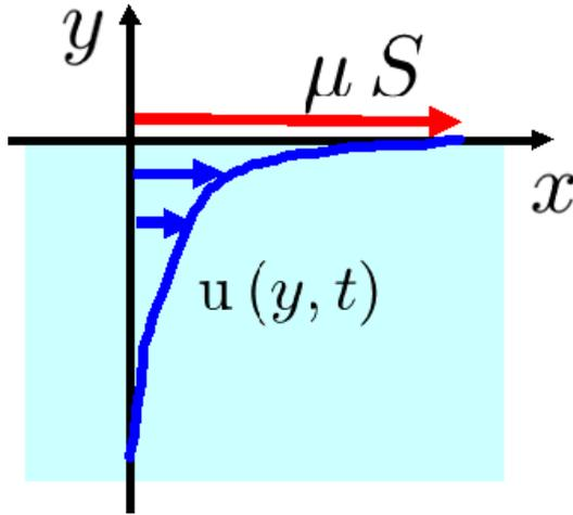
図 8.7.16: 自由表面に力が作用したときの流れ
