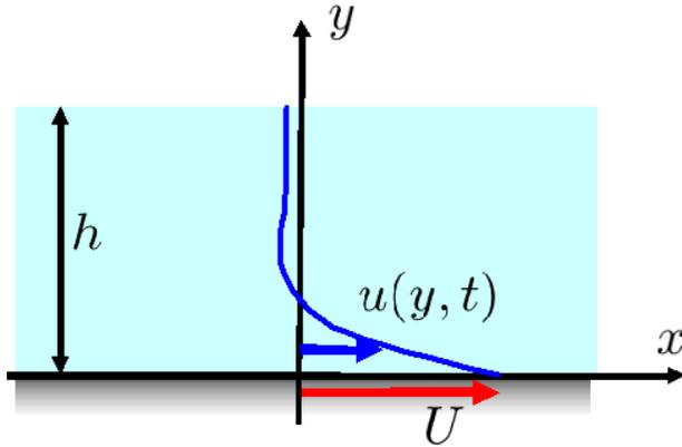
図 8.6.6: 自由表面を有する振動平板による流れ
