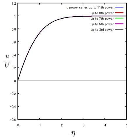
図 8.5.21:  $u$  流速分布 (次数の影響)  $\phi = 40\text{deg}$ .
