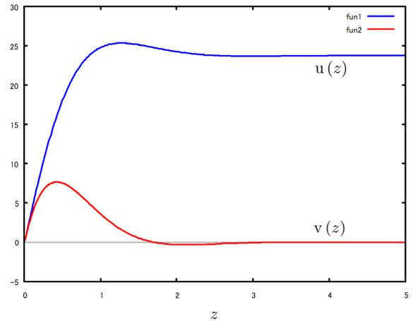
図 8.9.10: 地表面近くの流れ ( $\frac{d}{dx} p(x,y) = 0$  の時)
