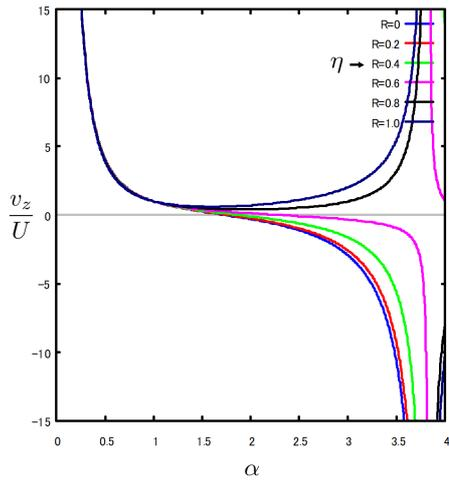
図 8.8.6: 軸流速:  $v_z$  径比:  $\alpha$  の影響  $\sigma = 1.0$
