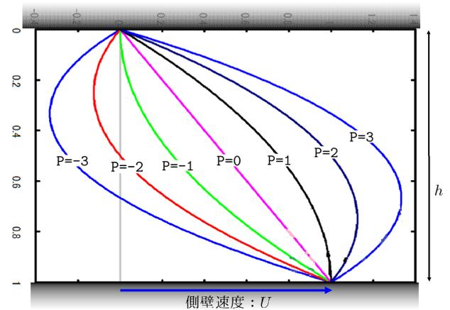
図 8.2.2: 一方の側壁が速度： $U$  で移動する場合の流速分布
