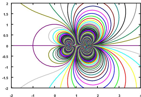
図 5.3.22: 円柱の外に置いた二重わき出しの流線 ( $\alpha = 0, \theta = 0$ )
