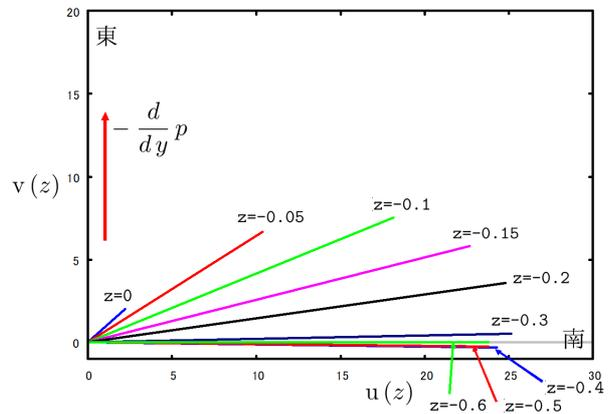
図 8.9.11: 地表面近くの流れ ( $\frac{d}{dx} p(x,y) = 0$  の時)
