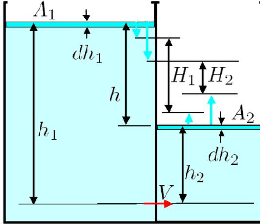
図 4.1.11: 下部開口部でつながった二つのタンクの液面変化
