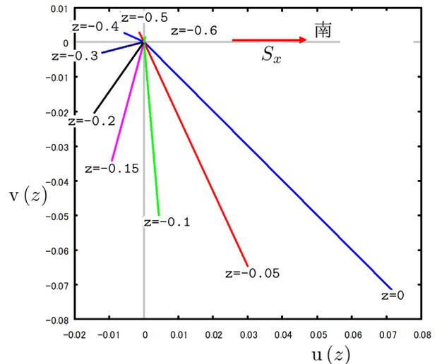
図 8.9.4: 海表面近くの流れ ( $S_x$  のみ)
