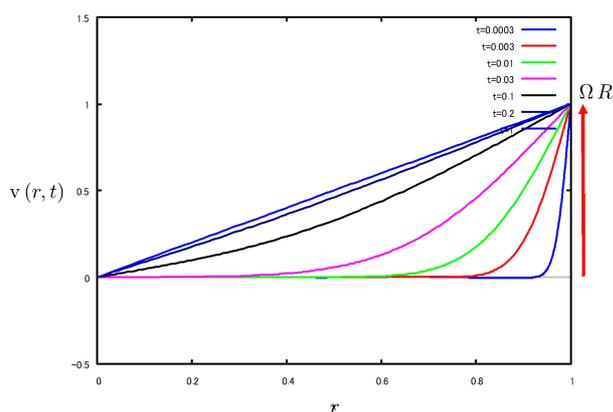
図 8.7.13: 円筒内静止流体で突然回転した円筒の流れ
