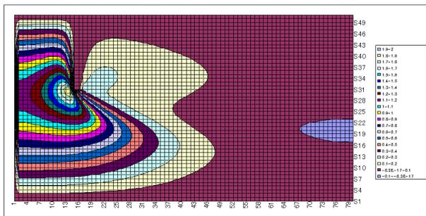
図 8.10.13: 垂直平板  $Rn = 100$  流速 :  $v$
