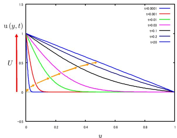
図 8.7.7: 突然動き出した平板と静止平板の間の流体流れ
