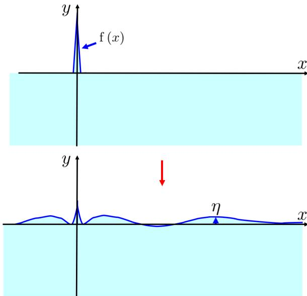
図 9.3.1: 自由表面のもりあがりによる二次元波の伝搬
