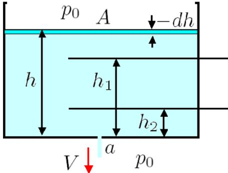
図 4.1.8: 柱状タンクの下端からの流出
