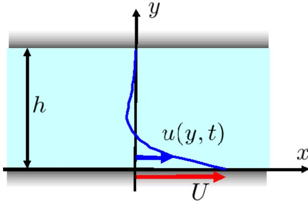
図 8.6.3: 平行平板内での振動平板による流れ
