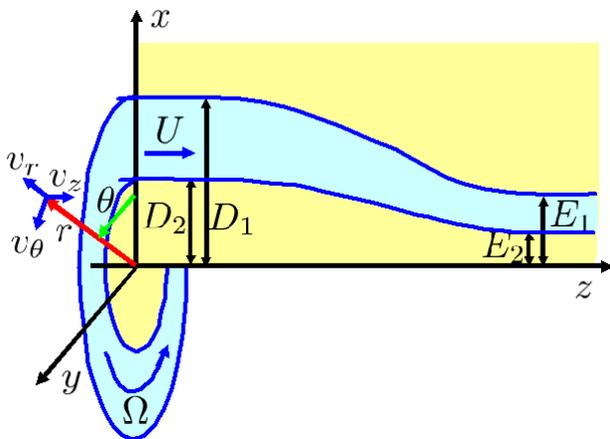
図 8.8.1: 旋回流を有する定常軸対称流
