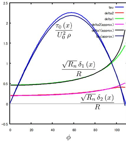
図 8.5.33: おしわけ厚さ： $\delta_1$ 、運動量厚さ： $\delta_2$ 、剪断応力： $\tau_0$ の級数解と近似解の比較
