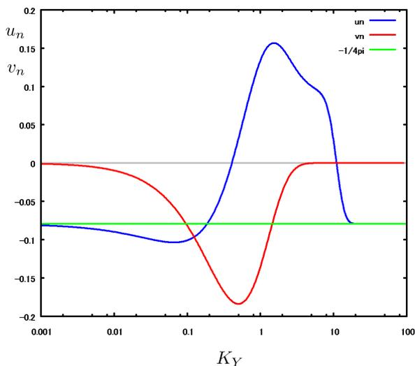
図 9.3.27: 水中翼位置における誘導速度 横軸:  $K_Y$
