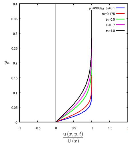
図 8.7.23: 流速分布の時間経過  $\phi = 90deg.$
