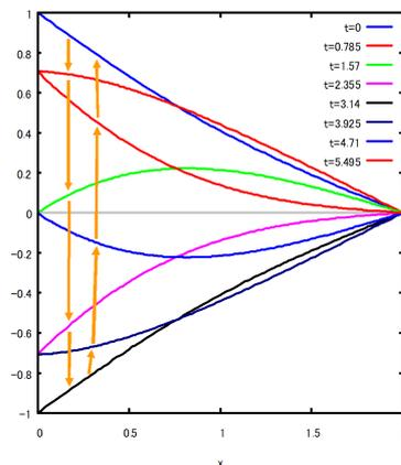
図 8.6.5: 平行平板内での振動平板による流れ  $h=2$
