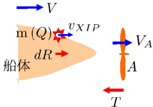
図 7.3.8: プロペラと船体との干渉力
