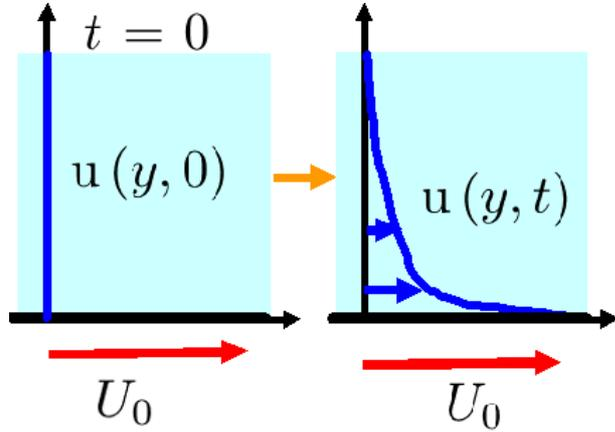
図 8.7.3: 静止流体中突然動き出した平板
