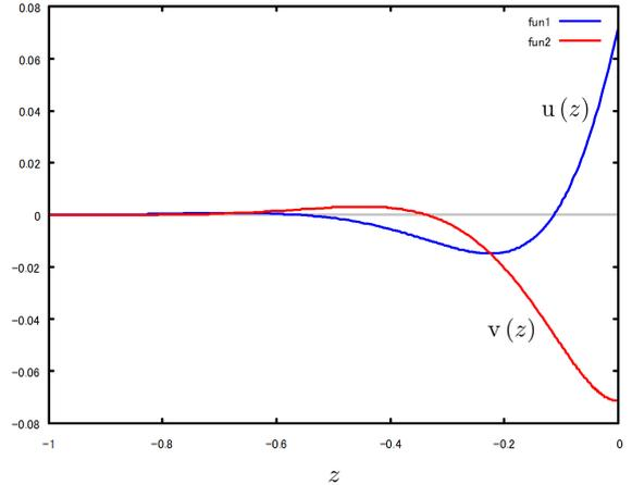
図 8.9.3: 海表面近くの流れ ( $S_x$  のみ)
