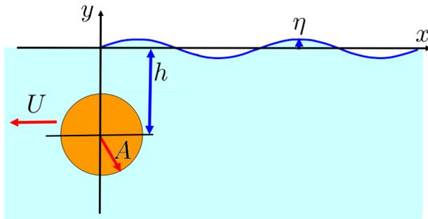
図 9.3.8: 没水二次元円柱による波
