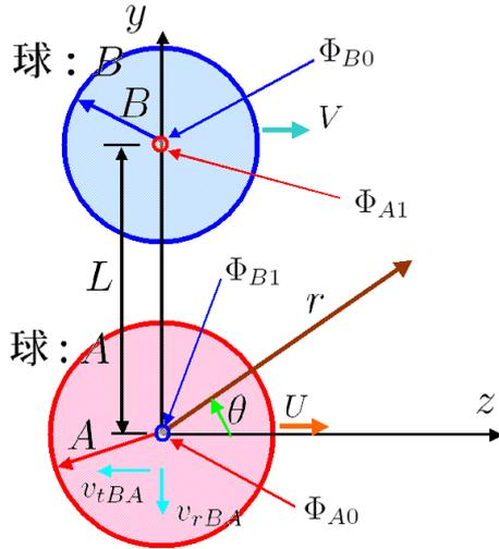
図 6.2.11: 一定速度で平行して動く 2 つの球の相互干渉
