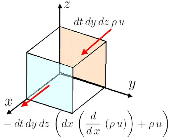
図 2.2.1: 流体要素で  $x$  軸方向に出入りする質量
