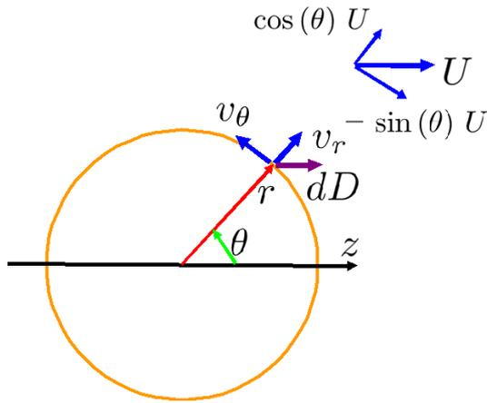
図 8.4.3: 三次元軸対称の Stokes 流れ
