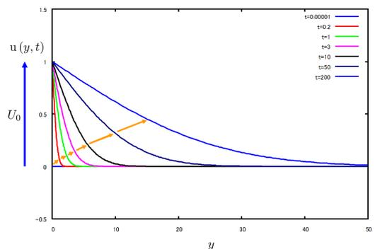
図 8.7.5: 静止流体中突然動き出した平板
