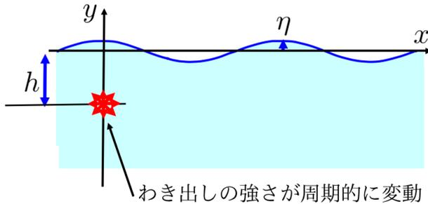
図 9.3.13: 周期的に変動するわき出し強さによる波
