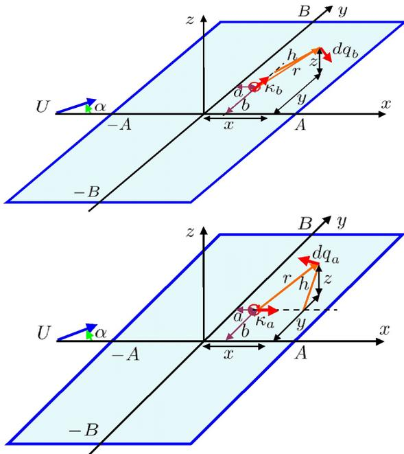
図 7.2.5: 渦度： $\kappa_a$ 、渦度： $\kappa_b$  による誘導速度
