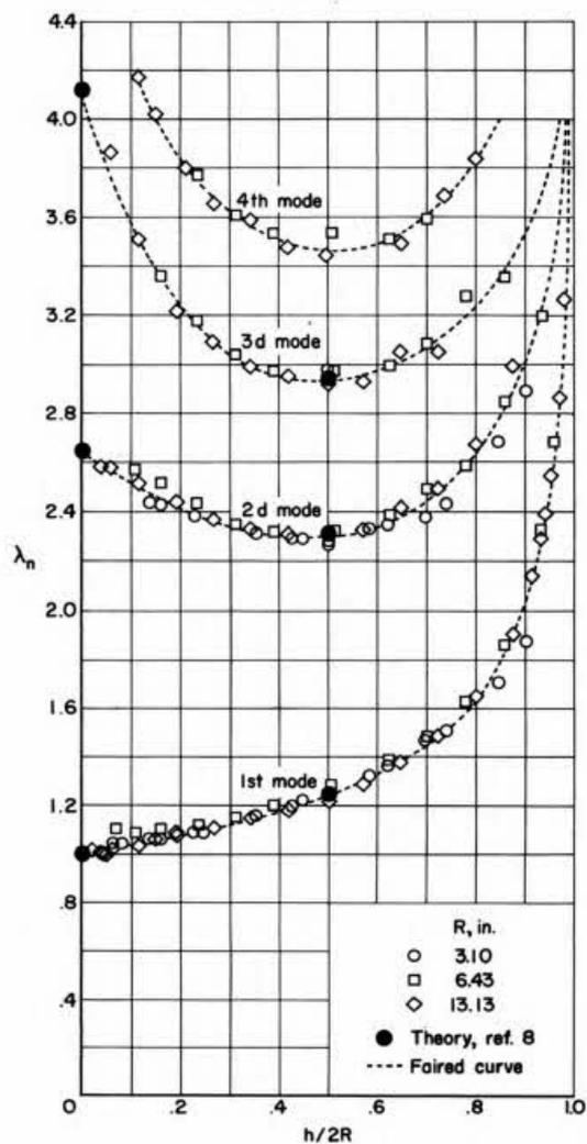
図 9.6.33: 球形タンクの荷液の固有円周波数
