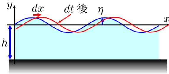
図 9.2.2: 波面の進行速度：位相速度
