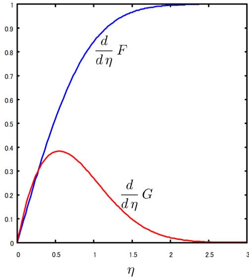
図 8.7.20:  $\frac{d}{d\eta} F, \frac{d}{d\eta} G$  の結果
