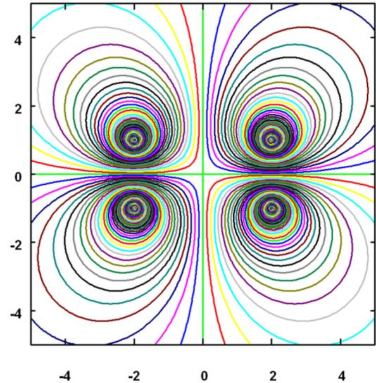
図 5.3.46: 直交する壁に置いた渦の流線 ( $\Gamma = 1$ 、渦位置:  $x_0 = 2, y_0 = 1$ )
