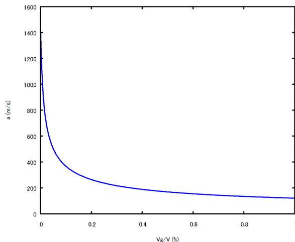
図 4.3.4: 管内に空気が混入した場合の伝搬速度
