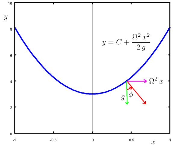
図 3.2.2: 回転する水の水面
