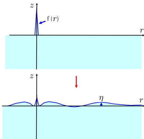
図 9.5.2: 自由表面のもりあがりによる平面波の伝搬
