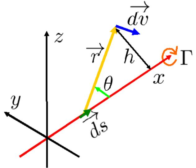
図 7.2.1: 渦循環による誘導速度
