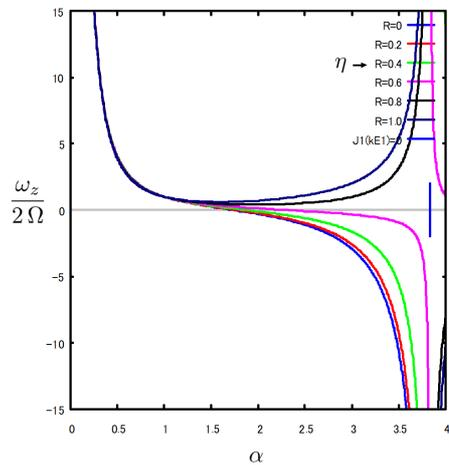
図 8.8.7: 軸方向渦度:  $\omega_z$  径比:  $\alpha$  の影響  $\sigma = 1.0$
