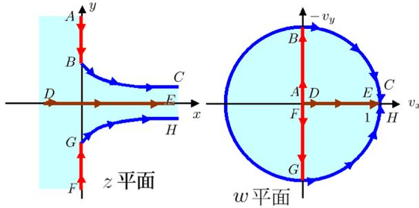
図 5.3.31: 平面壁のスリットから出る噴流
