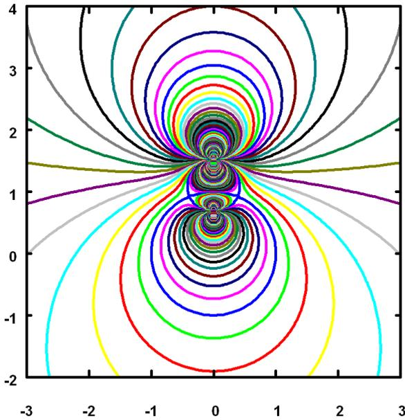
図 5.3.24: 円柱の外に置いた二重わき出しの流線 ( $\alpha = 0, \theta = \pi/2$ )
