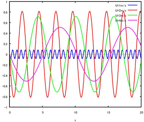
図 9.3.11: 没水二次元円柱による波
