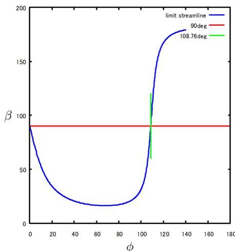
図 8.5.27: 限界流線の角度： $\beta$   $R_n = 1000$ ,  $\alpha = 45 \text{deg}$ .
