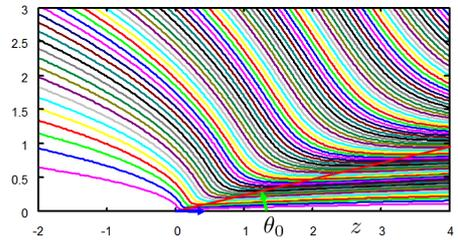
図 8.3.3: 細い管の先から流出するジェット  $C = 0.03$
