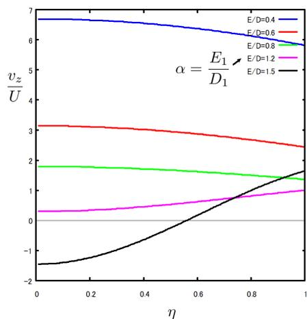
図 8.8.8: 軸流速:  $v_z$  半径方向分布  $\sigma = 2.0$
