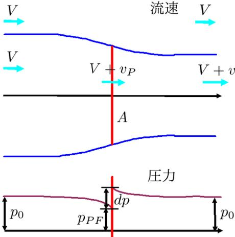
図 7.3.1: プロペラ軸方向運動量理論
