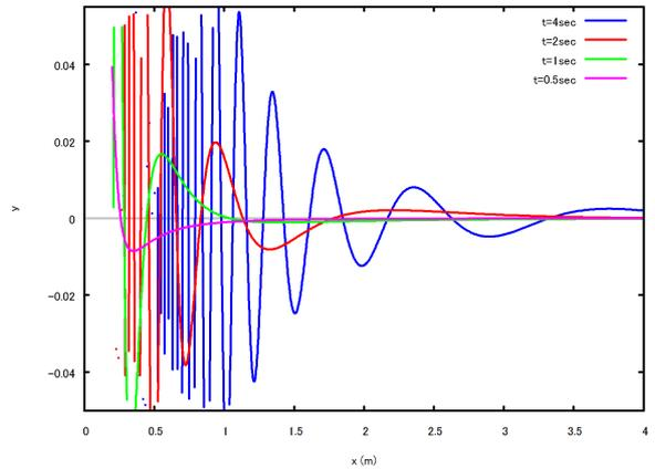
図 9.3.4: 撃圧作用による二次元波の伝搬
