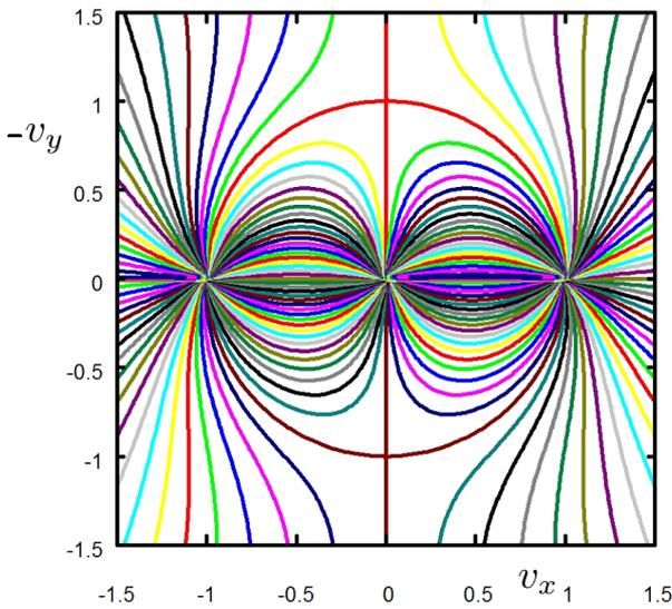
図 5.3.32: 平面壁のスリットから出る噴流の  $w$  平面の流れ
