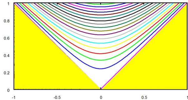
図 9.6.12: V 字断面水路 流線
