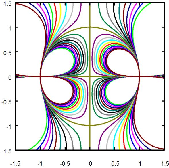
図 5.3.39:  $w$  平面の死水をともなう平板の流れ
