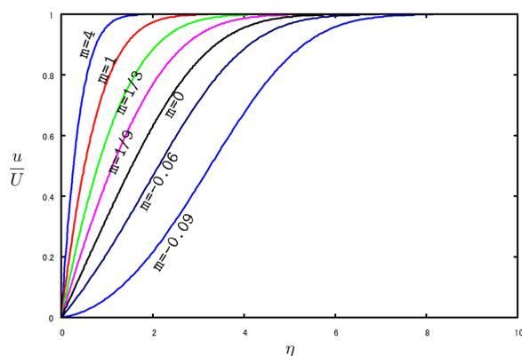
図 8.5.10: 二次元くさび形の外部境界層流速分布
