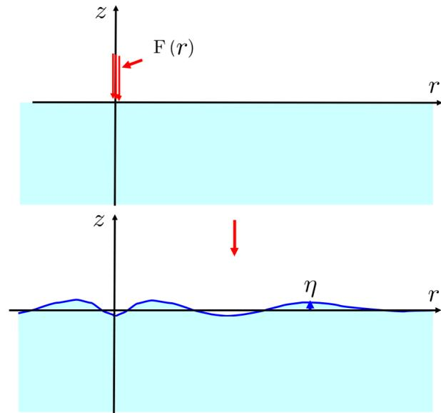
図 9.5.4: 衝撃圧力による二次元波の伝搬
