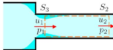
図 4.2.3: 断面積が不連続に急縮小する管路
