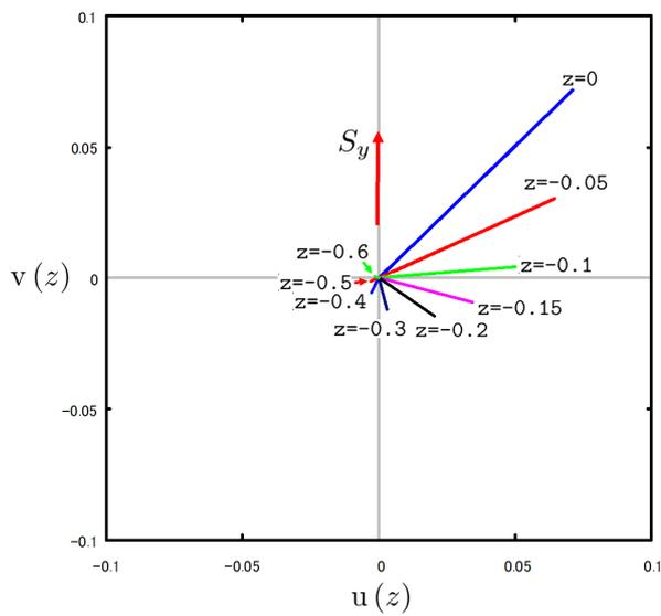
図 8.9.6: 海表面近くの流れ ( $S_y$  のみ)
