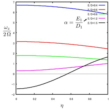
図 8.8.9: 軸方向渦度:  $\omega_z$  半径方向分布  $\sigma = 2.0$
