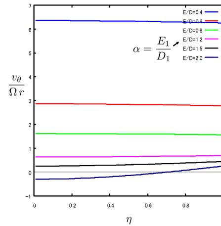
图 8.8.4: 旋回流速:  $v_\theta$  半径方向分布  $\sigma = 1.0$
