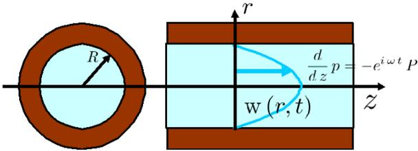
図 8.6.13: 円管内での変動圧力勾配による流れ
