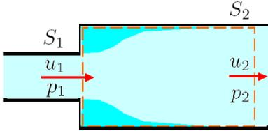
図 4.2.2: 断面積が不連続に急拡大する管路
