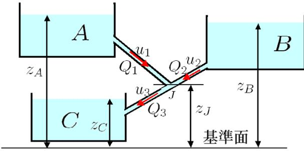
図 4.2.4: 貯水池を結ぶ分岐管路
