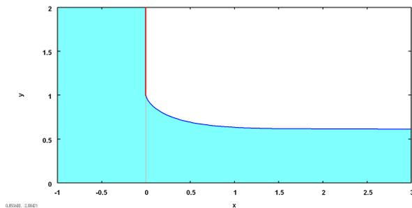
図 5.3.33: 平面壁のスリットから出る噴流
