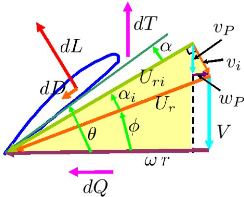
図 7.3.6: 運動量翼素理論のプロペラ断面流速ダイアグラム
