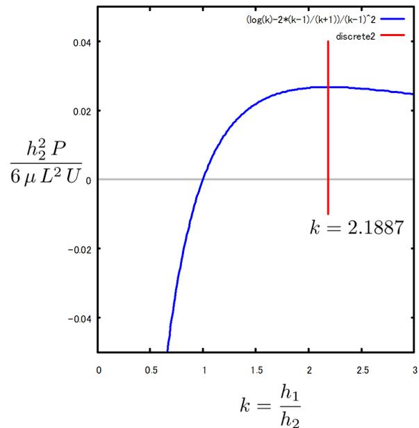
図 8.4.2: 平面のになう荷重： $P$  の  $k$  に対する特性
