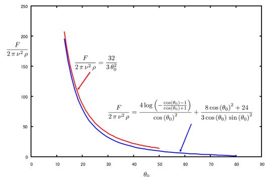
図 8.3.5: 細い管の先から流出するジェット ジェット推力と半角  $\theta_0$
