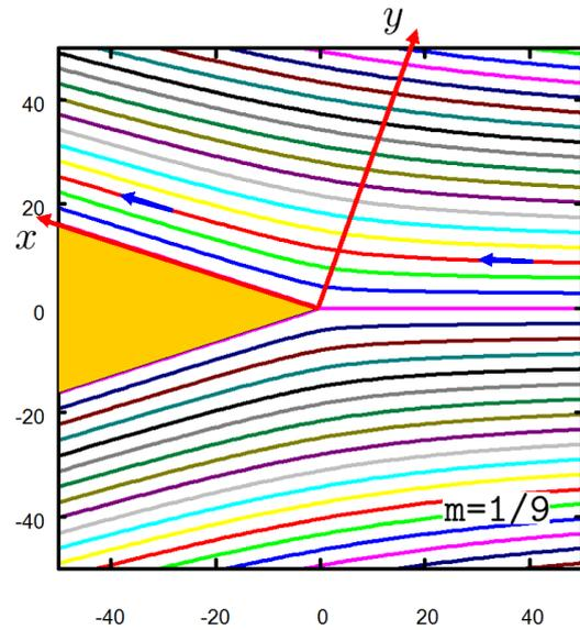
図 8.5.13: 二次元くさび形の外部流れ ( $m = 1/9$ )
