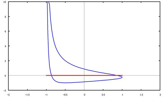
図 7.1.1: 二次元平板翼まわりの圧力分布
