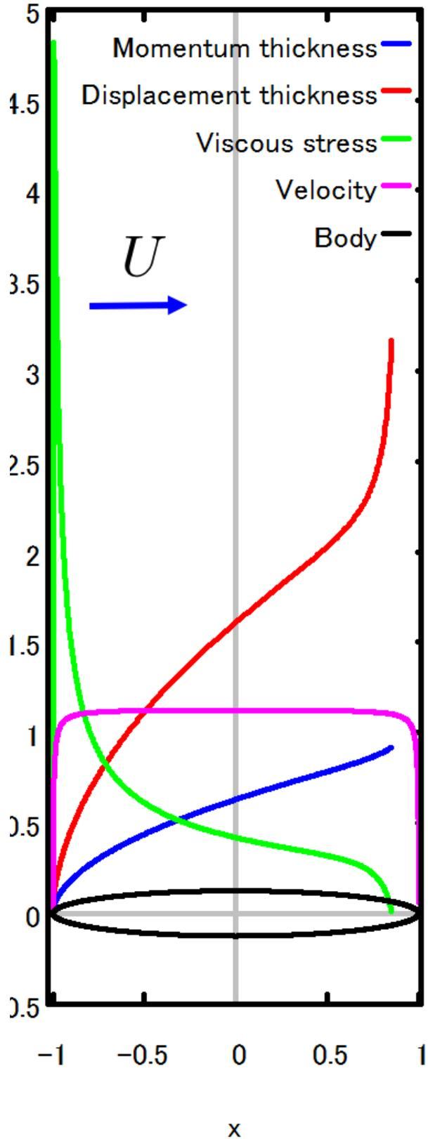
図 8.5.39: 楕円  $a/b = 8$  における運動量厚さ、おしのけ厚さ、剪断力、流速、楕円形状
