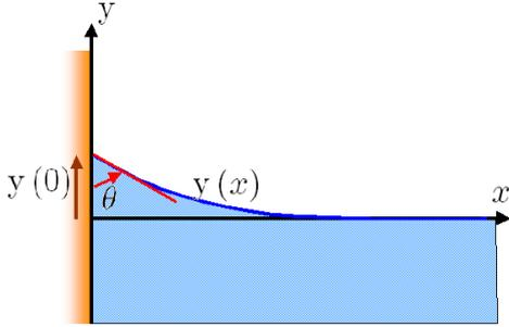
図 2.1.2: 垂直な壁と接する液体の表面
