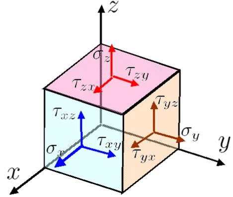
図 2.4.1: 流体要素表面に作用する応力
