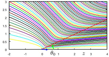
図 8.3.2: 細い管の先から流出するジェット  $C = 0.1$
