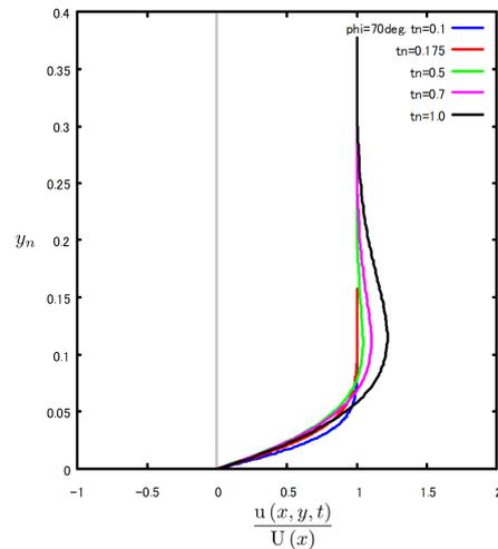
図 8.7.22: 流速分布の時間経過  $\phi = 70deg.$
