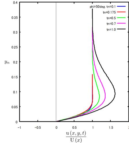
図 8.7.21: 流速分布の時間経過  $\phi = 50deg.$
