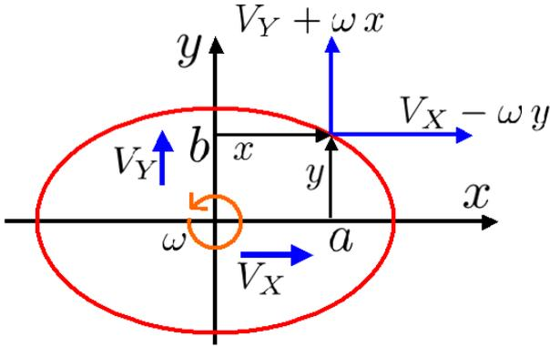
図 5.3.14: 運動する楕円柱まわりの流体運動エネルギー (楕円座標変換)
