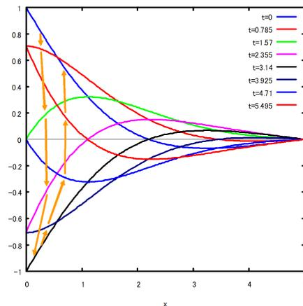
図 8.6.4: 平行平板内での振動平板による流れ  $h=5$
