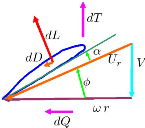
図 7.3.5: 単純翼素理論のプロペラ断面流速ダイアグラム
