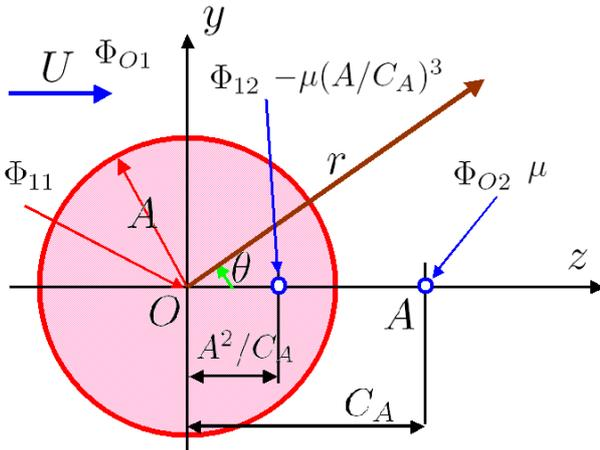
図 6.2.9: 球の外部に二重わき出しがある流れ
