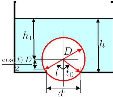
図 3.1.3: 水タンクの底の球
