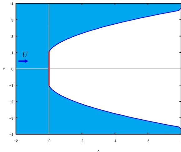
図 5.3.40: 垂直な平板の死水をともなう流れ
