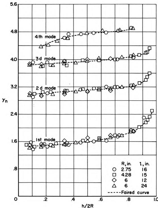
図 9.6.30: 水平円筒タンクの縦（長さ）方向の荷液の固有円周波数
