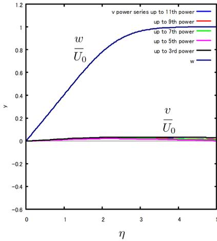
図 8.5.24:  $v, w$  流速分布 (次数の影響)  $\phi = 80\text{deg}$ .
