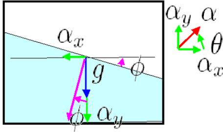
図 3.2.1: 直線加速中のタンクの水面
