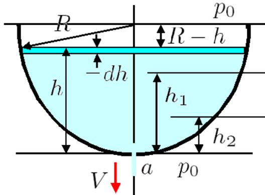
図 4.1.9: 半球タンクの下端からの流出
