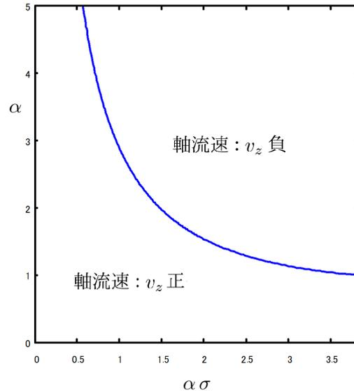
図 8.8.11: 軸流速： $v_z$  が正となる条件
