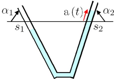
図 4.3.5: 一様な太さの U 字管の液体振動
