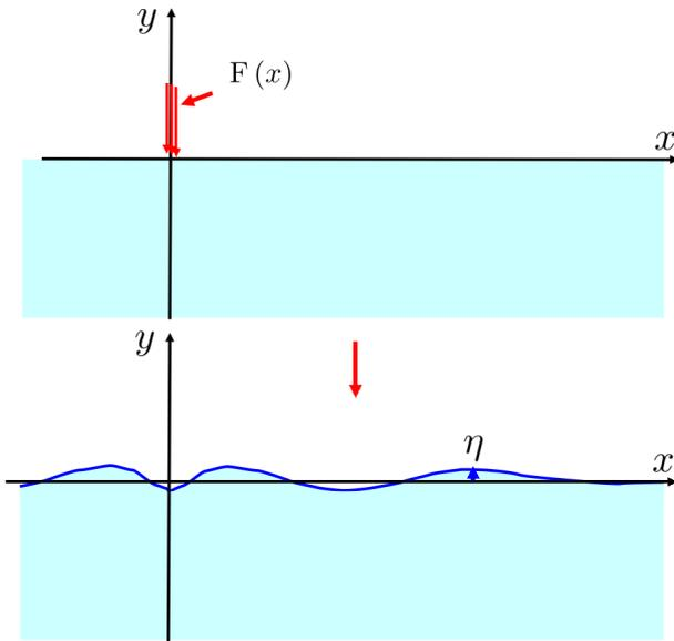
図 9.3.3: 撃圧圧力による二次元波の伝搬
