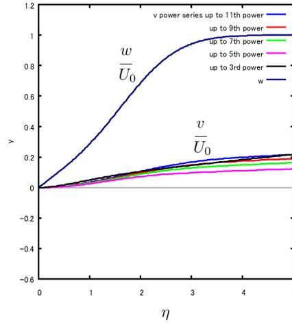
図 8.5.26:  $v, w$  流速分布 (次数の影響)  $\phi = 108.76\text{deg}$ .
