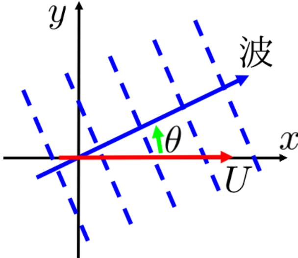
図 9.4.3: 三次元微小振幅波 (一様流)
