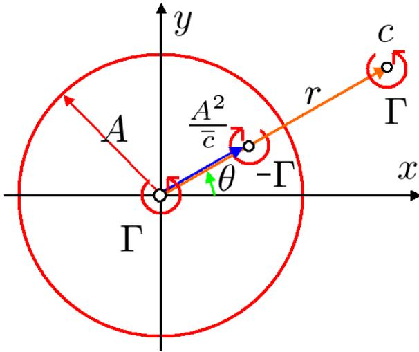
図 5.3.47: 円柱の外に置いた渦糸の運動
