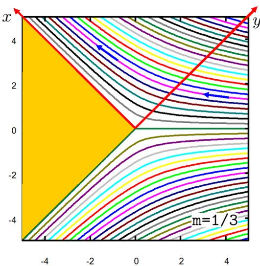
図 8.5.12: 二次元くさび形の外部流れ ( $m = 1/3$ )
