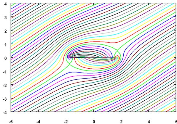
図 5.3.13: 一様流中の楕円柱まわりの流れ (Joukowski 変換)(5.3.24) 式による :  $\alpha = 30^\circ, a = 2, b = 1, U = 1$
