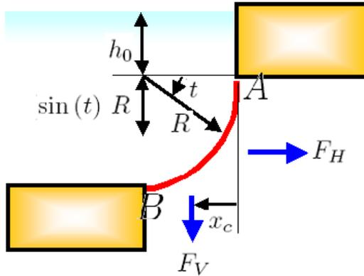
図 3.1.2: ゲートに作用する力
