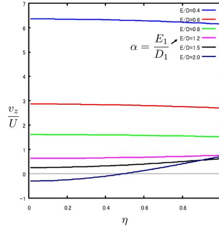
图 8.8.3: 轴流速:  $v_z$  半径方向分布  $\sigma = 1.0$
