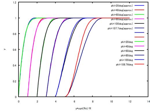
図 8.5.34: 境界層内流速分布の級数解と近似解の比較
