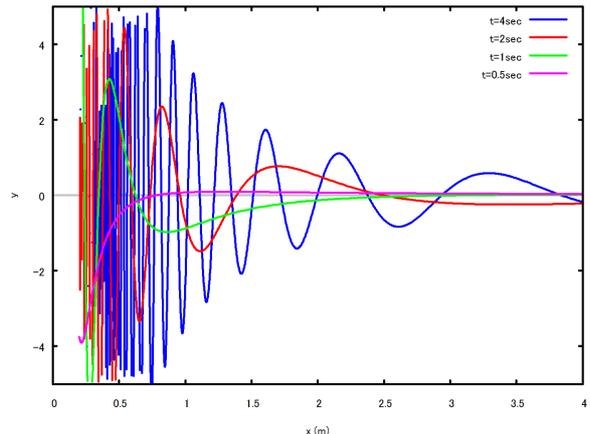
図 9.3.2: 自由表面のもりあがりによる二次元波の伝搬
