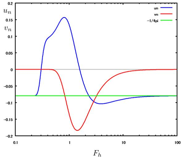
図 9.3.28: 水中翼位置における誘導速度 横軸:  $F_h$
