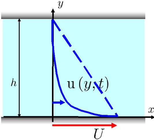
図 8.7.6: 静止流体中突然動き出した平板と静止平板の間の流体流れ
