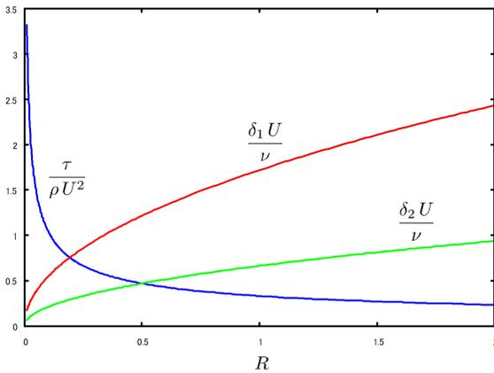
図 8.5.4: 剪断応力・おしのけ厚さ・運動量厚さの分布
