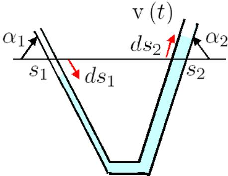
図 4.3.6: 断面積がゆるやかに変化する U 字管の液体振動
