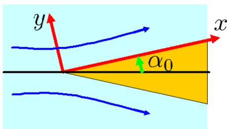
図 8.5.9: 二次元くさび形の外部流れ
