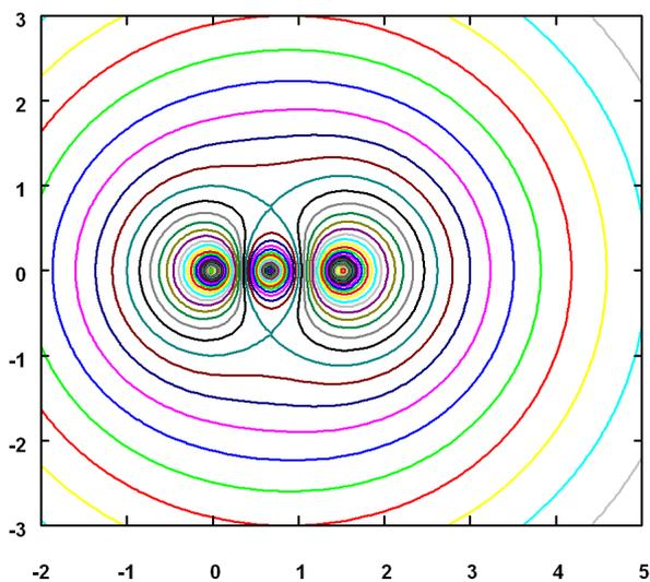
図 5.3.48: 円柱の外に置いた渦糸の流線 ( $\Gamma = 1, A = 1, r = 1.5, \theta = 0$ )
