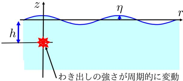
図 9.5.13: 周期的に変動するわき出し強さによる波
