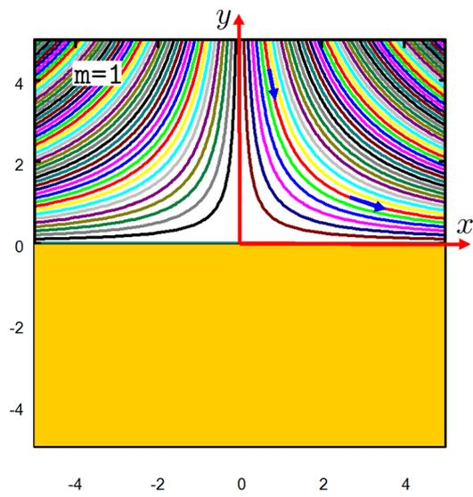
図 8.5.11: 二次元くさび形の外部流れ ( $m = 1$ )
