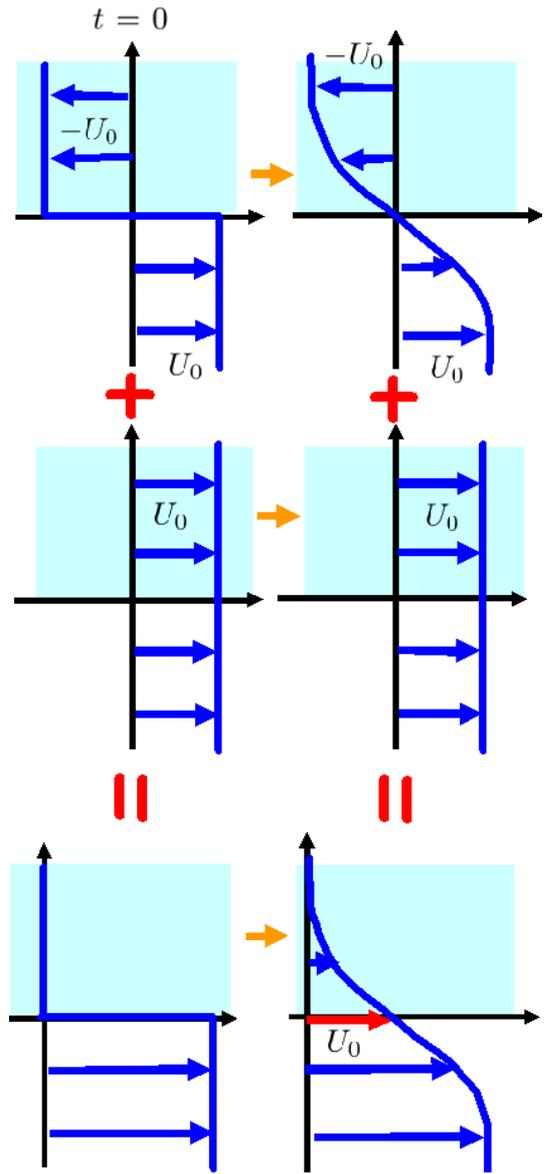
図 8.7.4: 静止流体中突然動き出した平板の模式図
