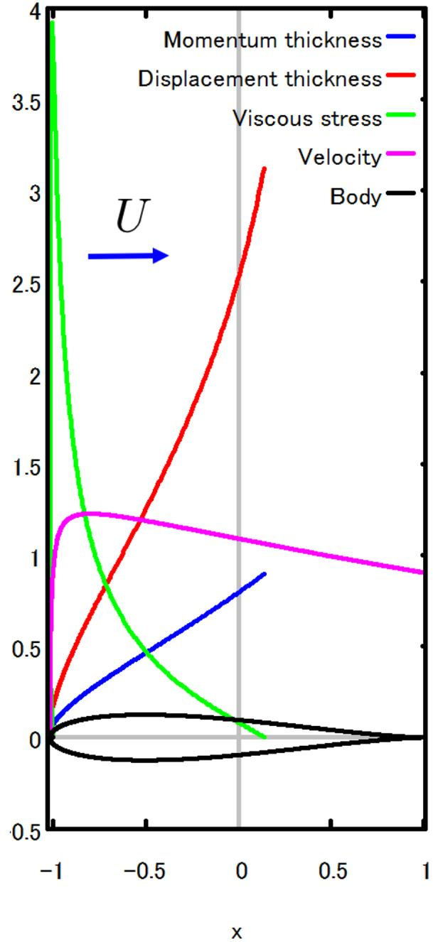
図 8.5.40: 翼形状 翼コード長さ/翼厚=8 における運動量厚さ、おしのけ厚さ、剪断力、流速、翼形状
