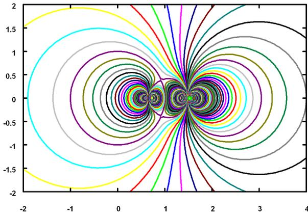
図 5.3.23: 円柱の外に置いた二重わき出しの流線 ( $\alpha = \pi/2, \theta = 0$ )
