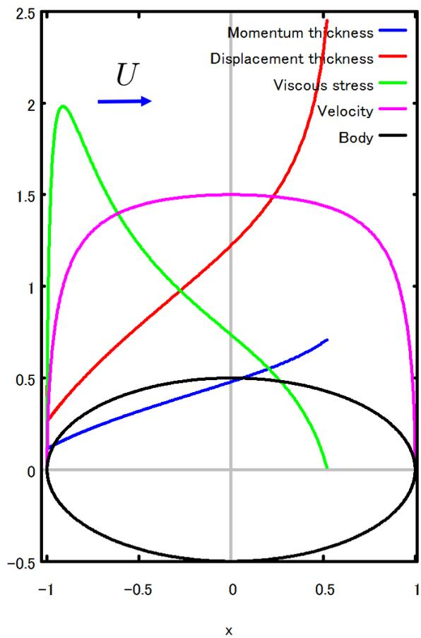
図 8.5.37: 楕円  $a/b = 2$  における運動量厚さ、おしのか厚さ、剪断力、流速、楕円形状
