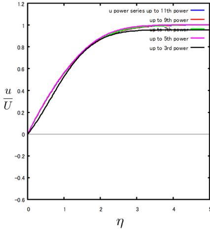
図 8.5.23:  $u$  流速分布 (次数の影響)  $\phi = 80\text{deg}$ .
