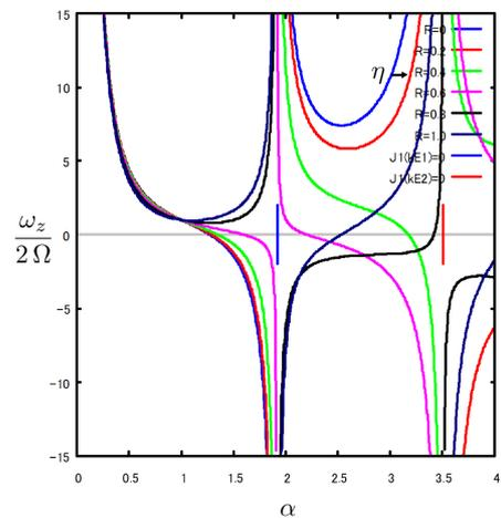
図 8.8.10: 軸方向渦度:  $\omega_z$  径比:  $\alpha$  の影響  $\sigma = 2.0$
