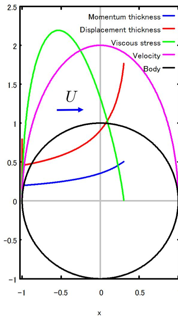
図 8.5.36: 楕円  $a/b = 1$  における運動量厚さ、おしのけ厚さ、剪断力、流速、楕円形状
