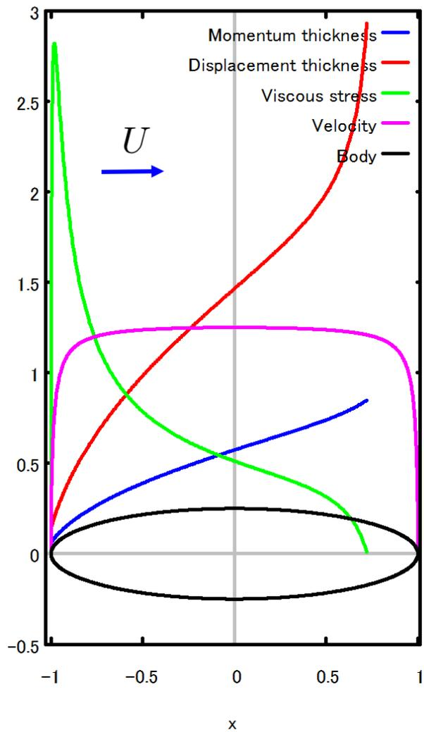
図 8.5.38: 楕円  $a/b = 4$  における運動量厚さ、おしのか厚さ、剪断力、流速、楕円形状
