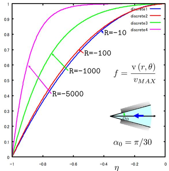
図 8.3.15: 二次元縮小流路流速分布 流速変化  $\alpha_0 = \pi/30$
