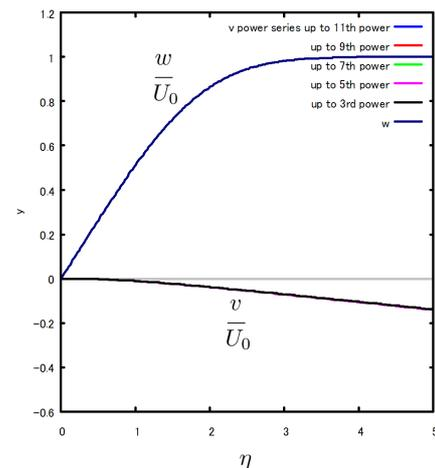
図 8.5.22:  $v, w$  流速分布 (次数の影響)  $\phi = 40\text{deg}$ .
