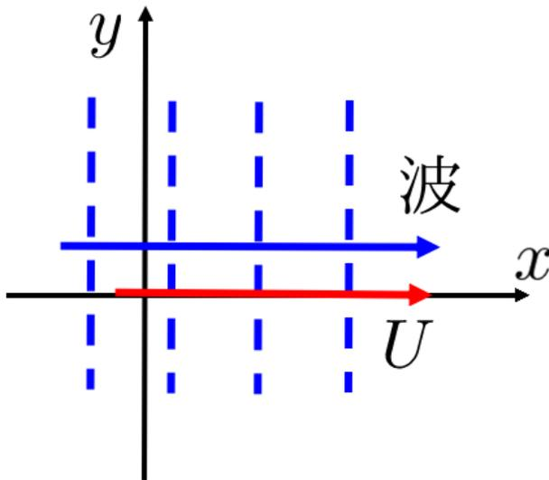
図 9.4.2: 三次元微小振幅波（一様流）
