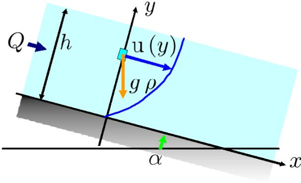
図 8.2.4: 傾斜した板の上の流体層
