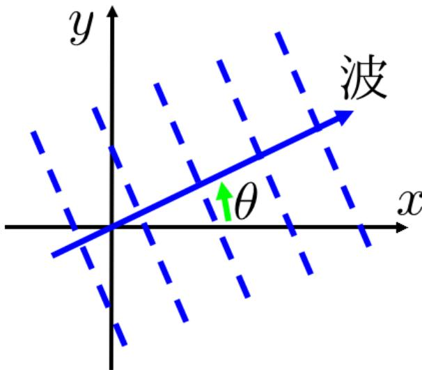
図 9.4.1: 三次元微小振幅波 (xyz 座標)
