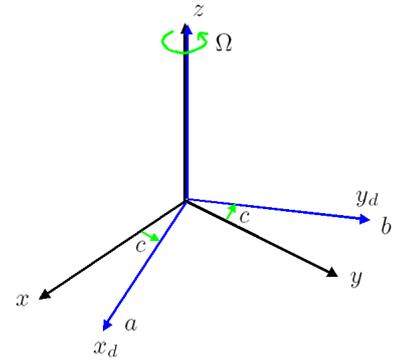
図 2.7.3: z 軸が回転する動座標系
