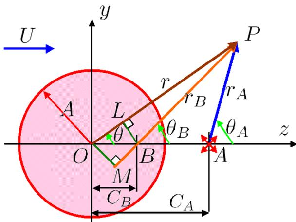
図 6.2.8: 球の外部にわき出しがある流れ
