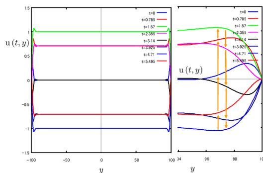
図 8.6.10: 平行平板内での変動圧力勾配による流れ  $h = 100$
