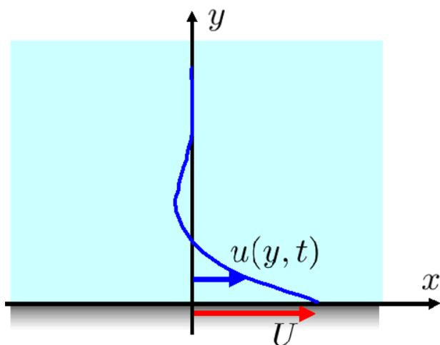
図 8.6.1: 振動平板による流れ
