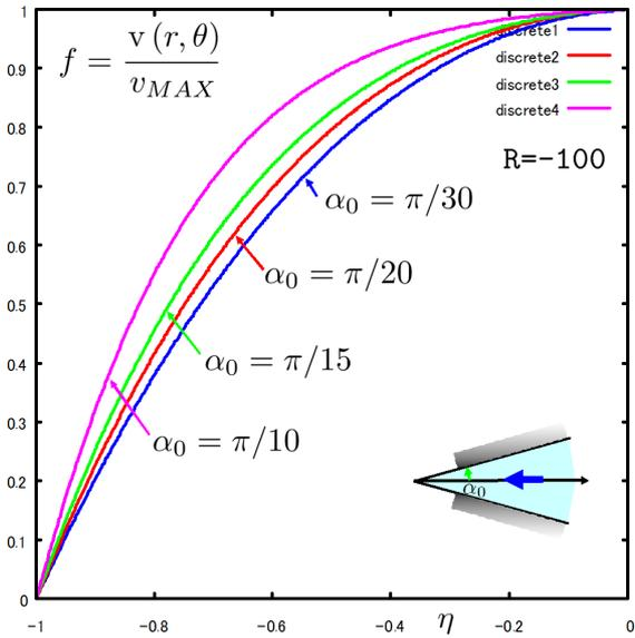
图 8.3.16: 二次元缩小平面流路流速分布 角度变化 R=-100
