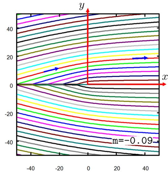
図 8.5.14: 二次元くさび形の外部流れ ( $m = -0.09$ )
